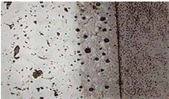
图14：瓷板显微照片，放大倍率约为 80 倍。
