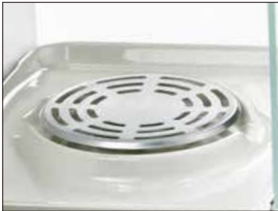
YSP01SQP 镂空秤盘, 直径80mm, 可有效减小 环境气流干扰, 提高称重性能, 适用 于0.01mg天平
