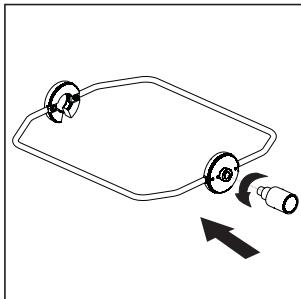
Schrauben Sie den entsprechenden Adapter von unten in den Gestellboden ein:
