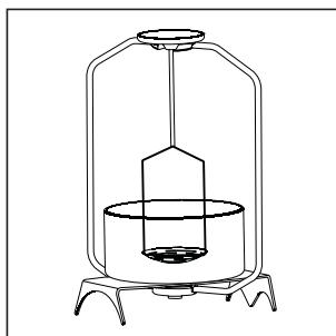
Pour déterminer les masses volumiques de solides quand elles sont supérieures à celle du liquide d'immersion, utiliser :
