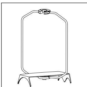
Setzen Sie das Gestell in den Wägeraum ein. Die keilförmige Öffnung oben am Gestell soll in die Richtung weisen, aus der der Tauchkorb (Tauchsieb/Gassenkörper) eingesetzt wird.
