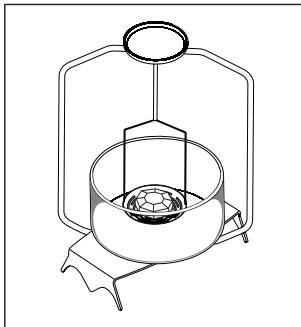
Dichtebestimmung von Flüssigkeiten:
