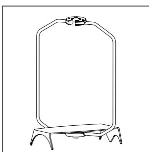
将支架放入称重室内。支架顶部的楔形开孔务必面向样品托盘（滤网/玻璃锤）将会放入支架内的方向。
